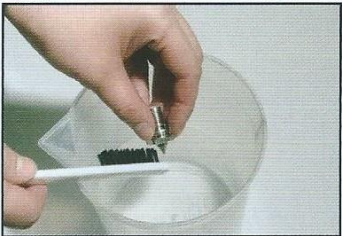
7. 17mmのメガネレンチにて塗料ノズルを外し、専用ブラシにて洗浄する。 Remove the fluid nozzle with a 17mm box end wrench and wash it with the exclusive brush
