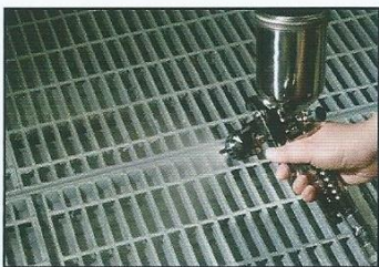
4. ブースの前でカップのシナーを捨て吹きする。約3回ほど繰り返し洗浄する。 Spray the thinner in front of a spraying booth. Repeat about 3 times.
