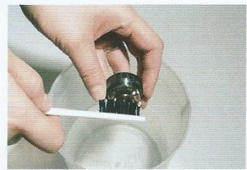
6. 空気キャップを外し、専用ブラシで洗浄する。 Remove the air cap and wash it with the exclusive brush
